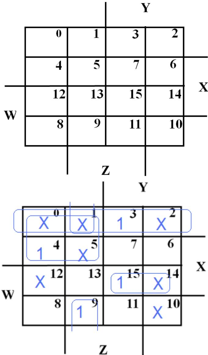
$$F(W, X, Y, Z) = \overline{W} \cdot \overline{X} + \overline{W} \cdot \overline{Y} + W \cdot X \cdot Y + \overline{X} \cdot \overline{Y} \cdot Z$$
