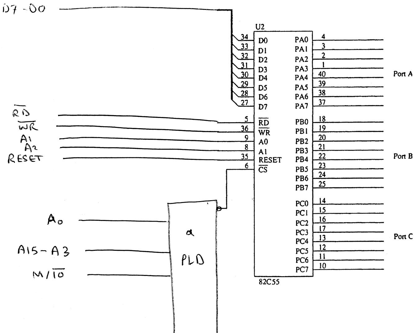
$$\overline{CS} = \frac{\overline{M/I/O} \cdot \overline{A_{15}} \cdot A_{14} \cdot \overline{A_{13}} \cdot \overline{A_{12}} \cdot \overline{A_{11}} \cdot A_{10} \cdot \overline{A_9} \cdot \overline{A_8} \cdot \overline{A_7} \cdot A_6 \cdot \overline{A_5} \cdot \overline{A_4}}{\overline{A_3} \cdot \overline{A_0}}$$
